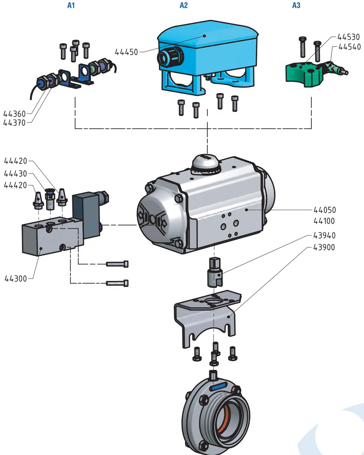
**ЗАТВОР ДИСКОВЫЙ С ПНЕВМОПРИВОДОМ 44160, 44210**
