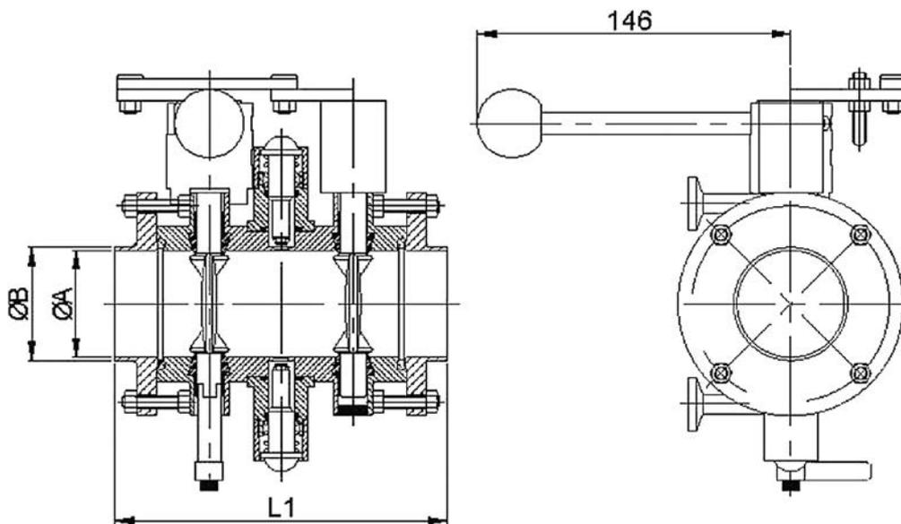
**ЗАТВОР С КОНТРОЛЕМ ПРОТЕЧКИ ДВУХДИСКОВЫЙ МЕЖФЛАНЦЕВЫЙ**
