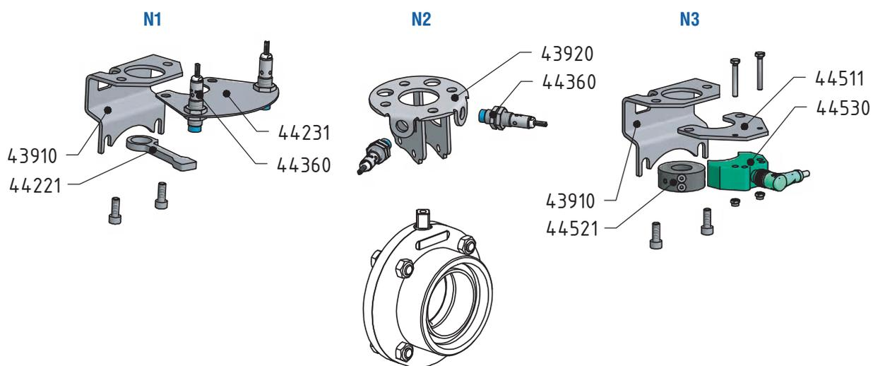
ЗАТВОР ДИСКОВЫЙ С ПНЕВМОПРИВОДОМ 44050, 44100
